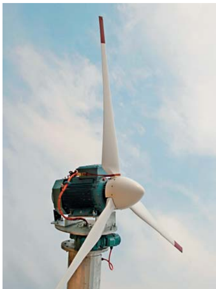
Die AGI Frost Fan is teen 'n 11°-hoek op die 9 m-paal gemonteer. Hierdie hoek is ná drie jaar se navorsing en ontwikkeling op Hoogland Boerdery bepaal as die doeltreffendste hoek waarteen hierdie waaiers werk. In die buiteland word hierdie waaiers meestal teen 'n hoek van 7° gemonteer.
