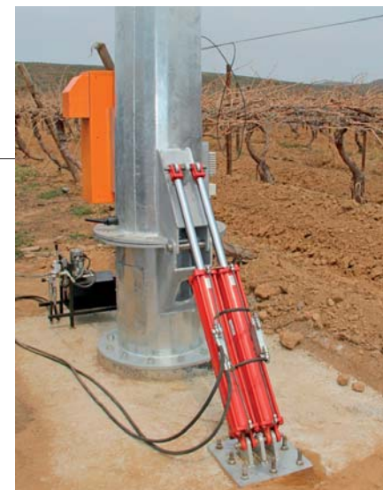
BO en LINKS: Die Frost Fans toring 9 m uit bo die wingerd naby Touwsrivier. Beveratech Ingenieurs het 'n slim plan ontwikkel om die toring met hidrouliese teleskooppompe te laat sak en op te lig, wat versiening en herstelwerk maklik maak. Dit help ook waar omgewingsimpakstudies nie 'n onooglike staaltoring sal toelaat nie. "Ons kan die torings deur die dag laat sak en snags, as ryp 'n risiko is, weer oplig," sê mnr. Christie van Zyl, vennoot by Beveratech.
